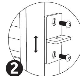
Držiak plotového pola **G** osadíme k rámu pomocou skrutiek **C**.
