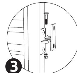
Držiaky plotového pola **G** spojíme pomocou skrutky **D**, podložky **E** a matice **F**. Tako skompletované plotové pole osadíme na miesto montáže a zapoložujeme na požadovanú výšku. Následne označíme otvory, ktoré budú slúžiť na ukotvenie samotného plotového pola.
