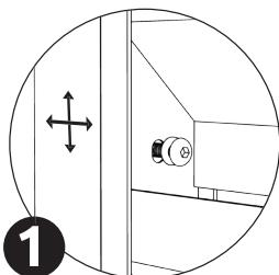
Výplň osadíme do rámu, vycentrujeme a uchytíme pomocou skrutiek **A** a podložiek **B**.
